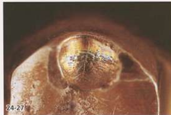
図24-27 金合金鑄造冠咬合面にパーシャルデンチャー(コバルトクロム合金鑄造床)のメタルフレームが7年間接触していた部で腐食が起こっている。
